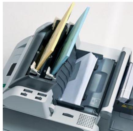
Para no parar el proceso, las dos estaciones se pueden cambiar al módulo tándem: cada estación trabaja sin interrupción cuando la otra se quede vacía, permitiéndole recargar la estación sin parar la máquina aumentando la producción.
